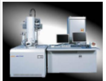
光学顕微鏡では見れない小さなものでも、電子顕微鏡なら大きく見えます。二つの点を区別できる能力が大きいければ大きいほど、より小さいものを区別できることになります。これを「分解能」と言いますが、電子顕微鏡は分解能が優れているとも言えます。サンプルに電気伝導がないと見れないので、電気を通さない物質には工夫が必要です。
